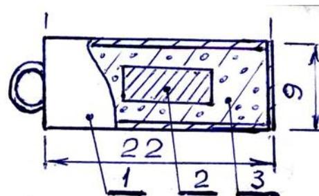
1. Корпус (сплав Cu + Ag)
